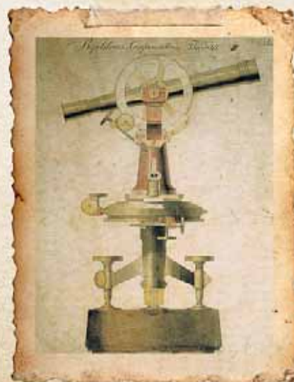
Repetitionstheodolit von 1835: colorierte Zeichnung aus der Werkstatt des Unternehmens F. W. Breithaupt & Sohn, Kassel. (Repro: IHK/Archiv)
